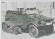
实验中的Pkw.K1 TYPE 155型军用车 The Pkw.K1 Kübelwagen Type 155 military vehicle undergoing tests
